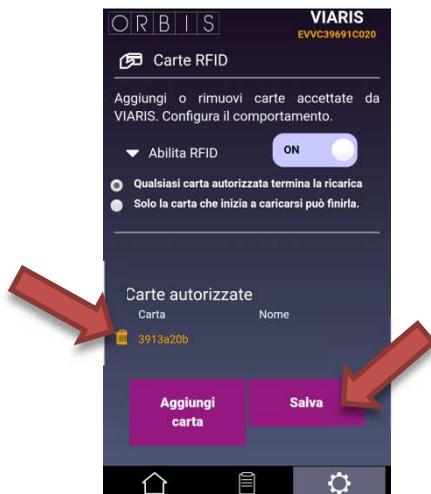
Per trasferire la configurazione delle **Card RFID** alla stazione di ricarica VIARIS, selezionare **Salva**.
